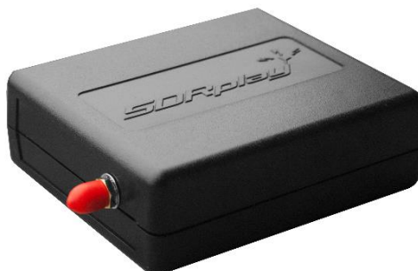
Fot. 4.3. Odbiornik RSP1A posiada plastikową obudowę i tylko jedno gniazdko antenowe SMA 50 \Omega . Pozostałe modele mają po trzy gniazda antenowe i metalowe obudowy ekranujące
