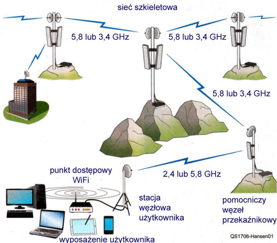
Rys. 8.1. Przykładowa struktura sieci. Węzły użytkowników są połączone z węzłami sieci bezpośrednio albo w miarę potrzeby przez pośredniczące węzły przekaźnikowe (źródło: [8.1])
