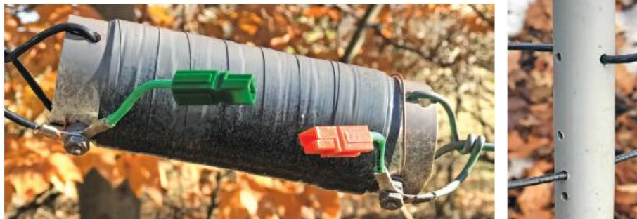
Fot. 1.1.5.5. Cewka przedłużająca dla pasma 80 m bez podłączonej zwory. Cewka jest owinięta taśmą izolacyjną dla stabilizacji uzwojenia i zabezpieczenia go przed wpływami otoczenia. Cewka została pomalowana na szaro ze względów estetycznych. Po prawej stronie znajduje się przewód dla pasma 80 m, a po lewej – główna część dipola dla pasma 40 m
