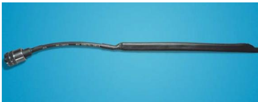
Fot. 1.2.12.3. Połączenie strojnika z resztą kabla
