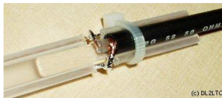
Fot. 4.2.7. Możliwy sposób zabezpieczenia przerwy za pomocą koszulki termokurczliwej Fot. 4.2.8. Możliwy sposób umocowania kabla na końcu anteny
