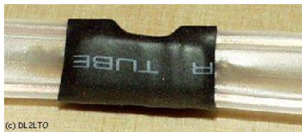
Fot. 4.2.7. Możliwy sposób zabezpieczenia przerwy za pomocą koszulki termokurczliwej Fot. 4.2.8. Możliwy sposób umocowania kabla na końcu anteny
