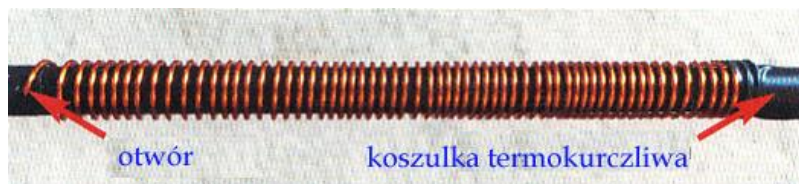
Rys. 1.2.2.2. Wykonanie cewki i doprowadzeń. Po lewej stronie widoczny otwór do wnętrza rurki, a po lewej sposób zabezpieczenia za pomocą koszulki termokurczliwej
