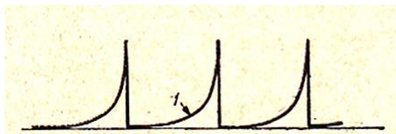
Rys. 1.1.10. Kształt impulsów prądowych w obwodzie anodowym lampy układu superreakcyjnego z samowygaszaniem
