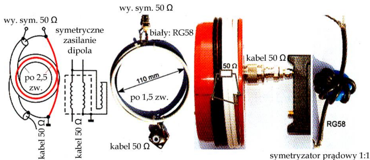
Rys. 7.4. Symetryzator ze zwiniętego kabla RG58 (białym) z dodatkowym uzwojeniem z drutu (w kolorze czarnym), źródło: DF6SJ „Kurze Antennen”
