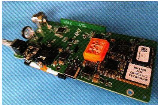
Rys. 8.3. Widok płytki wzmacniacza mocy sporządzony w KiCadzie
