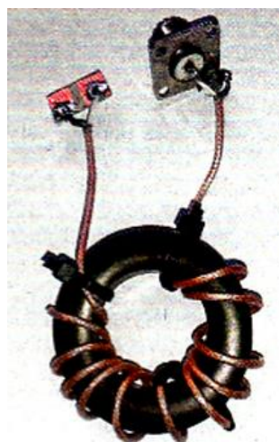
Rys. 7.6. Konstrukcja i zasilanie dipola na przykładzie dipola na pasmo 30 m. Długości ramion obliczono ze wzoru l [m] = 72,25 / f [MHz] . W wykonaniu ze skrętki ramiona stanowią rozciągnięte końce odcinka skrętki
