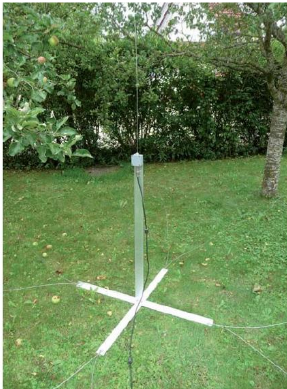
Fot. 15.2. Antena ENAMS. Na ziemi widoczne przeciwwagi
