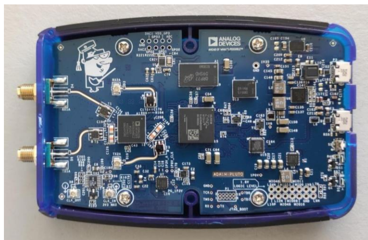
Fot. 18.5. Konstrukcja wewnętrzna Pluta
