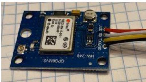
Fot. D.3 i D.4. Podłączenie odbiornika GPS do T-Decka . Odbiornik należy włączyć za pomocą polecenia --gps on
