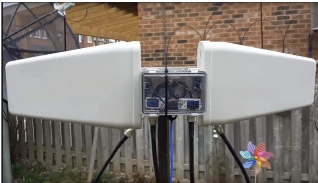
Fot. 3.1.3. Węzeł przekaźnikowy Meshtastic złożony z dwóch modułów Heltec i dwóch anten logarytmiczno-periodycznych
